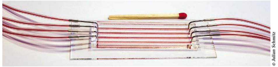
Abb. 1: Durchfluss-Modell mit vier parallel verlaufenden Kanälen. Per Lithographie wird eine Maske für das Modell erstellt, welche anschließend mit PDMS abgeformt wird. Die kovalente Bindung des PDMS an den Objektträger erfolgt durch Sauerstoff-Plasma-Behandlung.
