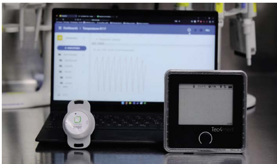
Abb. 2: SensorSpot der Firma essentim (vorne links) sowie ein SmartHub der Firma Tec4Med (vorne rechts) zum automatisierten Upload der Temperatur- und GPS-Daten in das Temperaturdashboard des Labor-Ausführungs-Systems der Firma Labforward (Hintergrund).
