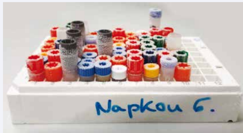
Abb. 1: Fehlende Harmonisierung bei den Kryo-Gefäßen führt zu über 20 verschiedenen Gefäßarten an 36 Standorten. Das Foto von Dr. Michael Müller (Charité) zeigt Plasma-Aliquote aus der systematischen Probenanalyse in NAPKON.
